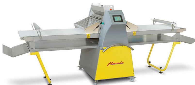
Fig. 3.2.5. Laminator pentru aluatul foietaj (franțuzesc)
